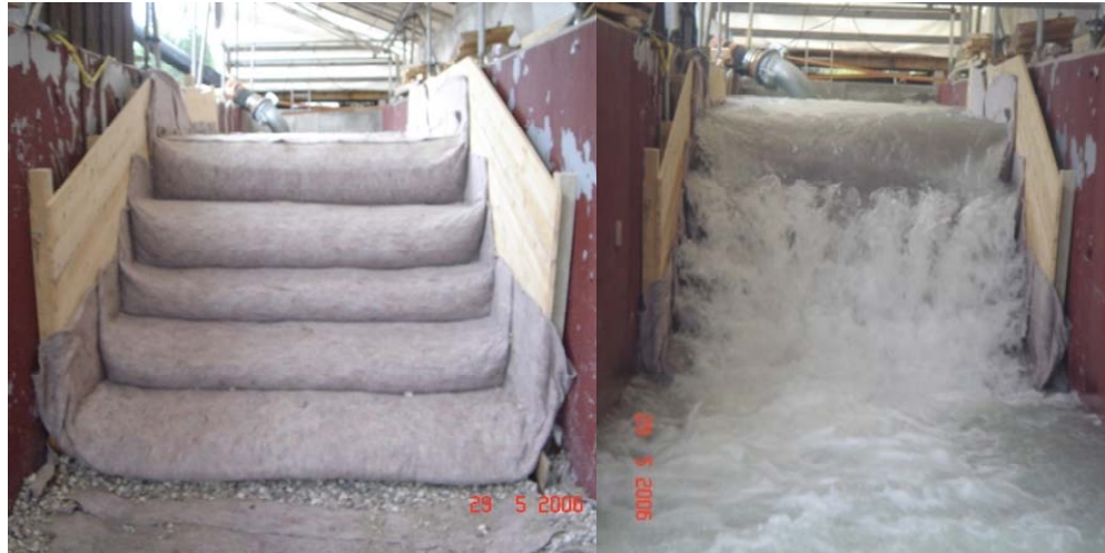
Abbildung 4.4-2 Versuch 05 vor/nach Überströmung (links), während Überströmung (rechts)
