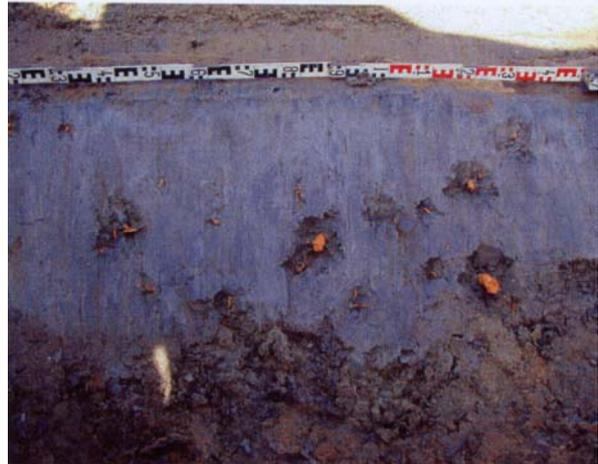
Abb. 20: Durchwurzelte Dichtung eines Dammes (aus Kunz 2001)
