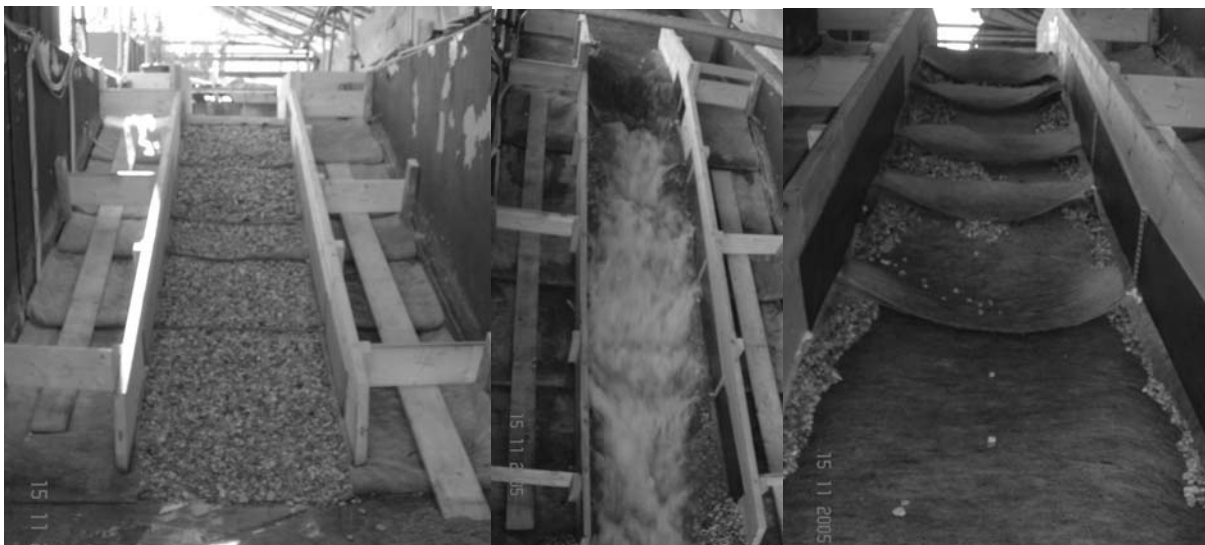
Abb. 9: Versuchsaufbau (links), überströmter Deich (Mitte) und Deich nach Überströmung (rechts) mit waagrechten Bahnen bei einer Überströmbreite von 1,0 m
