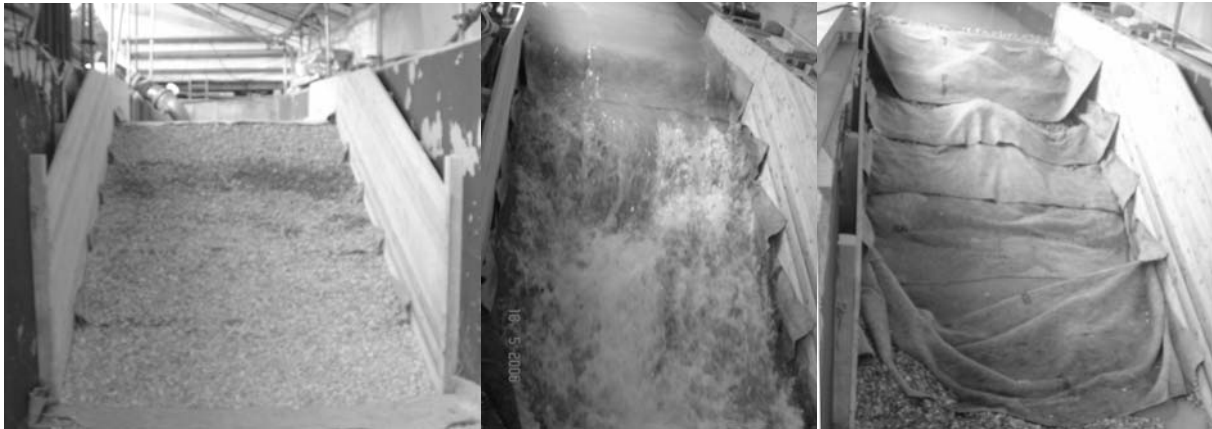
Abb. 10: Versuchsaufbau (links), überströmter Deich (Mitte) und Deich nach Überströmung (rechts) mit waagrechten Bahnen bei einer Überströmbreite von 2,3 m
