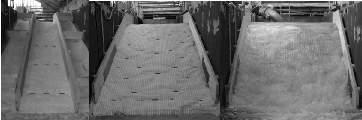
Abb. 11: Versuchsaufbau Raster 0 (links) und Raster 1 (Mitte) und überströmter Deich (rechts) der mit Bodennägel fixierten böschungsp parallelen Bahnen (Geogitter-Vliesstoff-Kombinationen)
