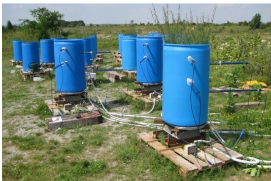
Abbildung 6: Lysimeter-ähnliche Versuchsanordnung (Deutsch-Wagram, 18.08.2009).
