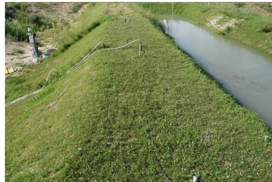
Abbildung 3: Mit Gräser-Kräuter-Vegetation beplanter Bereich während eines Durchsickerungsversuches (Deutsch-Wagram, 19.06.2008)
