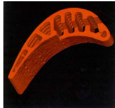
Abb. 3: Tomographisches Ergebnis einer Turbinenschaufel.
