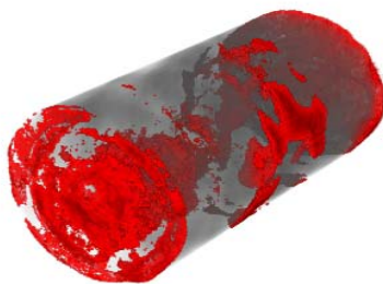
Abb. 8: 3D-Darstellung von Probe 1 mittels Neutronen-Computer-Tomographie.
