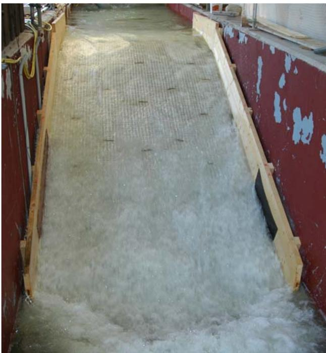
Bild 7: Methode (II) – Überströmung mit böschungparalleler Sicherung mit Geogitter-Vliesstoff-Kombinationen (vernagelt), Neigung  $1:n = 1:2,5$ ,  $q = 300 \text{ l/(s}\times\text{m)}$  (8)
