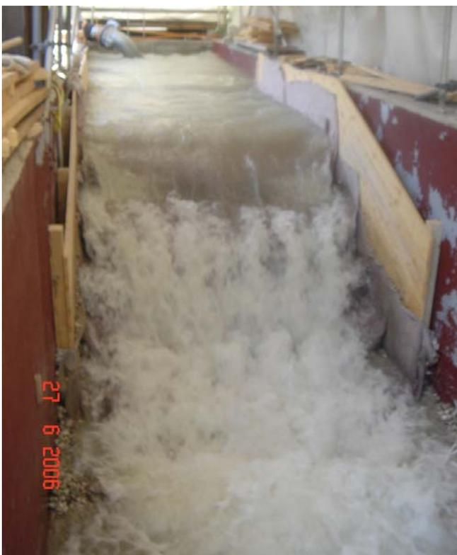
Bild 8: Methode (III) – Überströmung mit integrierter Sicherung aus Wasserbaufiltervliesstoffen, lagenweise umgeschlagen, Böschungsneigung  $1:n = 1:1,5$ ,  $q = 130 \text{ l/(s}\times\text{m)}$  (8)
